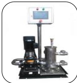
待机状态时，清洗球停留在注球器内；系统启动时，清洗球从注球器注入空调冷却水管洗管，回球器带有可视窗口，可观察球体状态并可以看到回球数量。
